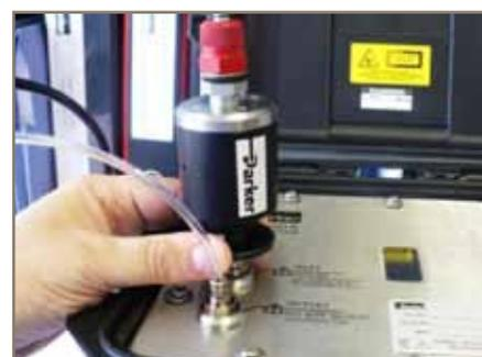
Для снятия редукционного клапана нажмите на съемник, одновременно поднимая клапан.
