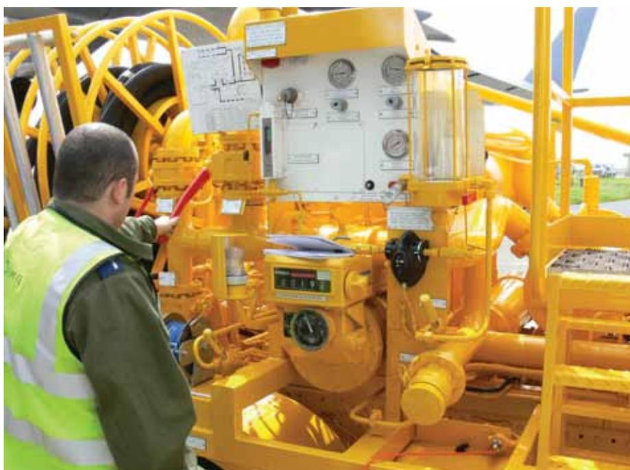
В этой системе топливо закачивается в самолет с использованием icountPD для контроля по принципу "прошел/не прошел".
