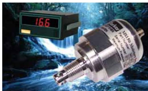
Измерение влажности гидравлического и смазочного масла в оперативном режиме. Серия датчиков влажности компании Parker обеспечивает быстрое, надежное и точное определение содержания воды в рабочих жидкостях в работающей системе. Технология первичного преобразователя MS-типа создавалась, прежде всего, для использования в среде программы профилактического обслуживания.
